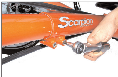
Lösen der Klemmschrauben zum Verstellen des Tretlagerauslegers.
