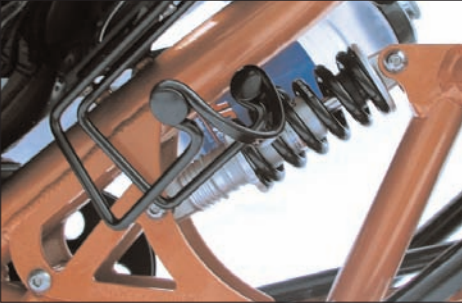
Federelement mit Stahlfeder. Durch das Drehen des Einstellringes am vorderen Ende der Feder stellen Sie die Federvorspannung ein.
