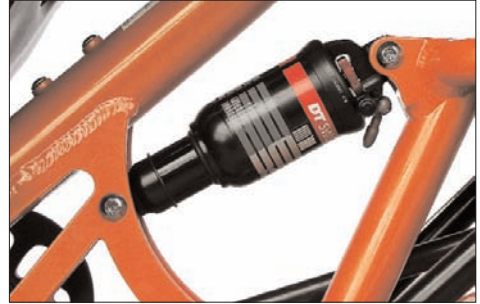
Federelement DT-Swiss XMI 80. Die Einstellung der Dämpfung erfolgt über das rote Rad am hinteren Ende. Das Federelement muss so eingebaut sein, dass der Kipphebel zur Blockierung am hinteren Ende nach unten zeigt, damit der Hebel beim Einfedern nicht an den Rahmen anschlägt.
