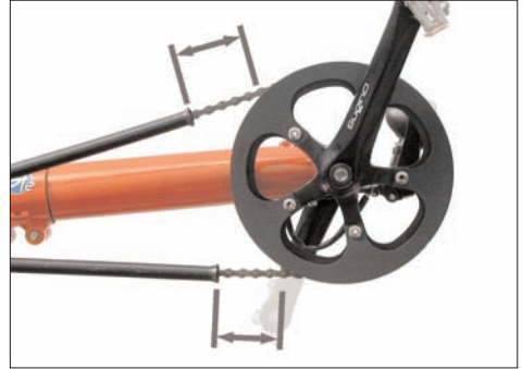
Zwischen den Enden der Kettenschutzrohre und den Schaltungsteilen müssen bei gespannter Kette mindestens 5 cm Abstand verbleiben.
