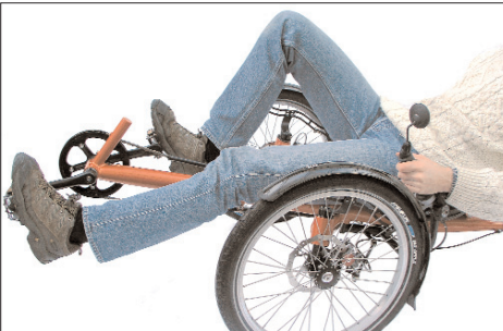
Der Tretlagerausleger wird so eingestellt, dass das Knie beim Fahren gerade nicht maximal durchgestreckt wird.
