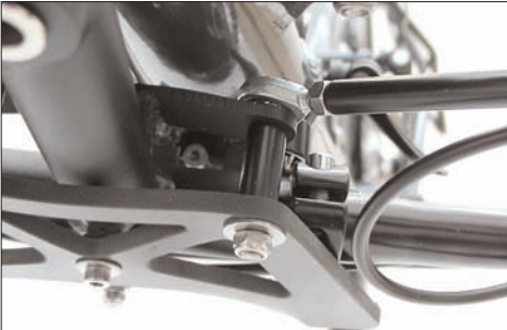
Scorpion fs: Auch hier wird zwischen Gelenkkopf und dem Halter am Vorbau eine Unterlegscheibe montiert.
