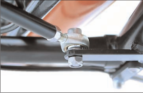
Scorpion / Scorpion fx: Der Gelenkkopf wird auf den Halter am Vorbau montiert, eine Unterlegscheibe liegt dazwischen.
